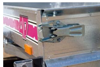
Kraftiga lämlås på fram och baklämmen.
