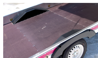
Inbyggda hjul medför en större och mer användbar lastyta samt smidigare yttermått.
