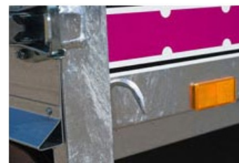
Krokar för surrning av lasten finns runt hela vagnen.
